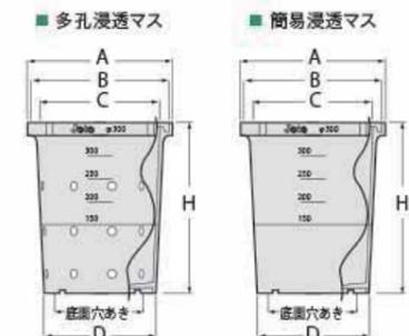
※多孔浸透マスは側面と底面に、簡易浸透マスは底面に穴を開けています。
