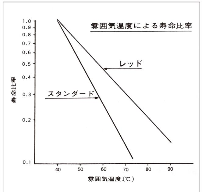
上のグラフは、霧困気温度が常温時のベルト平均寿命を1.0としたときの霧困気温度とベルト寿命の関係を表したものです。
