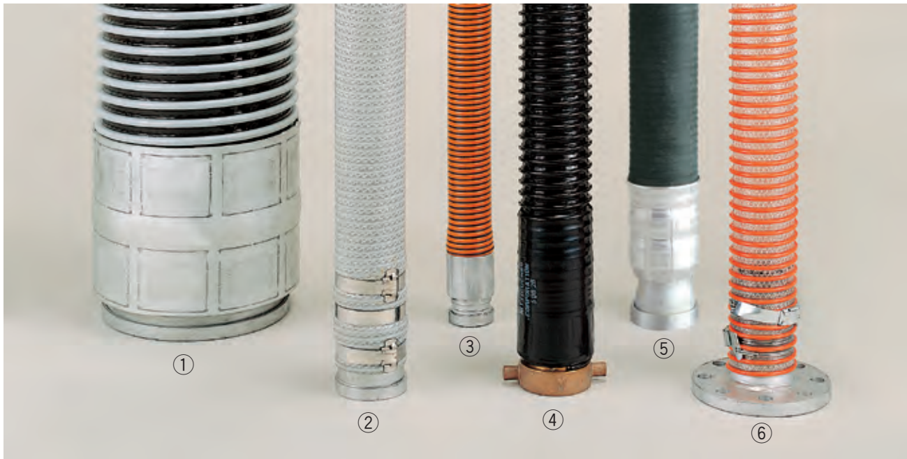
ホース取付け例 ①外筒加締 ②フープバンド締め ③内筒拡大外筒加締 ④ローリー用カップリング&アルミ加締 ⑤外筒加締(抜け止め) ⑥SEバンド締め
