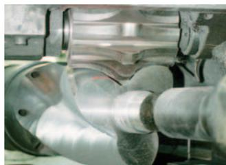
●ミーリングマシンによるロータの加工
